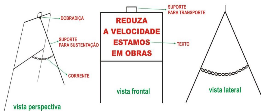
Figura 3: Cavalete em chapa galvanizada.
