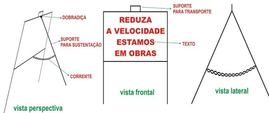
Figura 2: Cavalete em chapa galvanizada.
