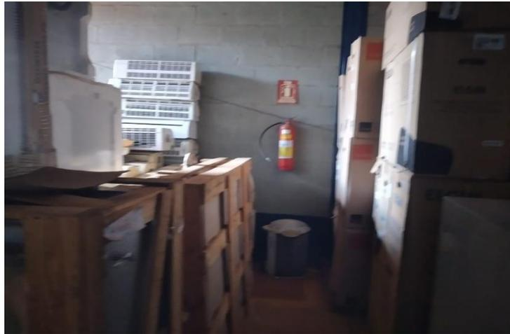
*Figura 8 - Acúmulo de materiais no acesso aos extintores*
