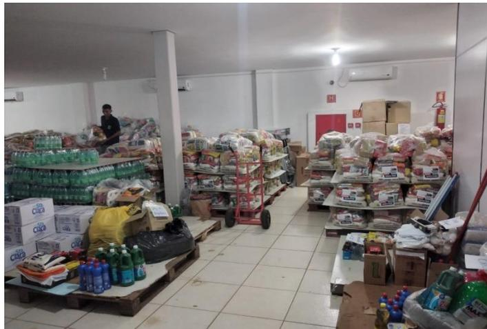
*Figura 9 - Acesso aos extintores obstruído*
